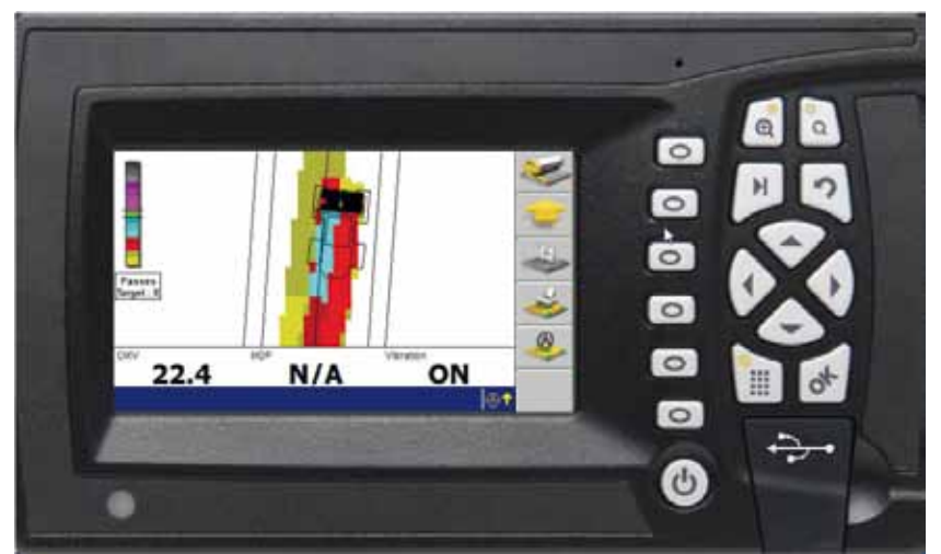
Fahrwege der Walze samt der bereits verdichteten Abschnitte sowie der noch nicht bearbeiteten Flächen werden farbig auf dem Monitor in der Kabine angezeigt.
